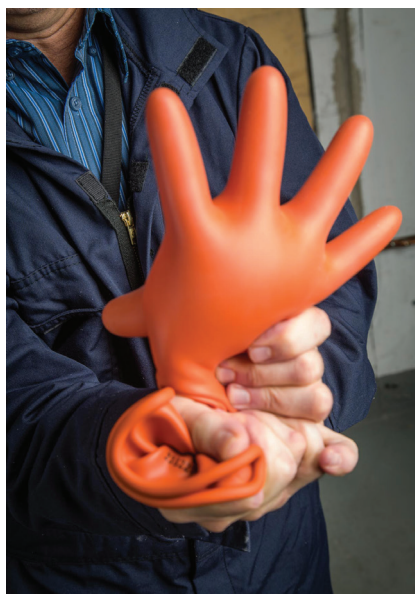
Le gonflage du gant permet de vérifier les fuites d'air.
