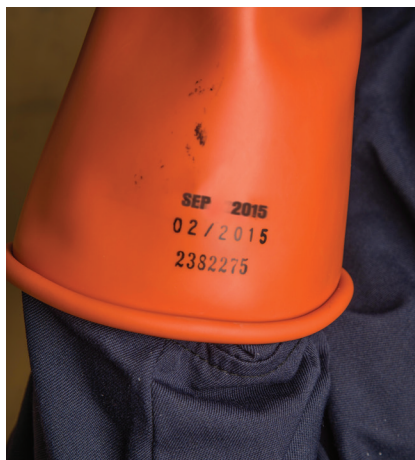
Les inscriptions imprimées sur ce gant indiquent que les tests diélectriques ont été faits en février 2015 et en septembre 2015.
